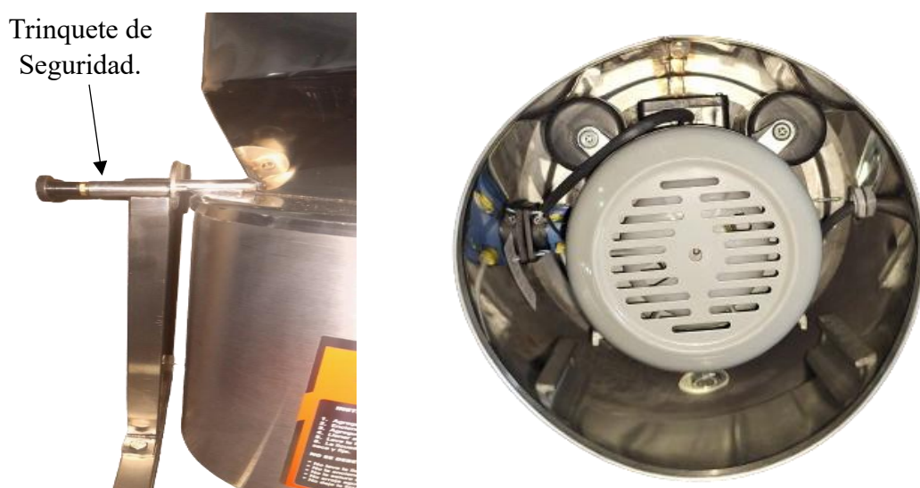
Figura # 1. Trinquete de Seguridad y detalle de Ventilación del Motor parte Inferior Abierta.
