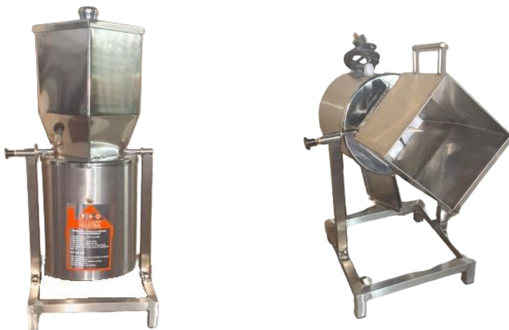
Figura # 6. Licuadora Industrial Basculante en sus Dos Posiciones. Vertical y Horizontal.
