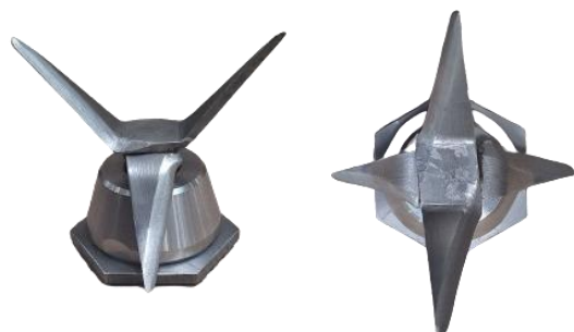
Figura # 4. Detalle del Acople y la Cuchilla en Acero Inoxidable 304 de 4 Aspas.
