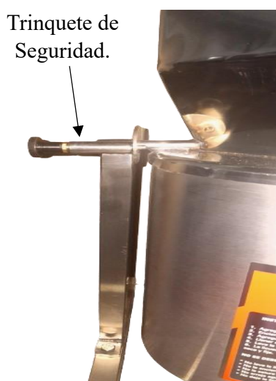
Figura # 1. Trinquete de Seguridad y detalle de Ventilación del Motor parte Inferior Abierta.
