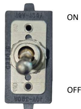
Figura # 5. Botón tipo Codillo para Encendido y Apagado. Licuadora de 5L.
