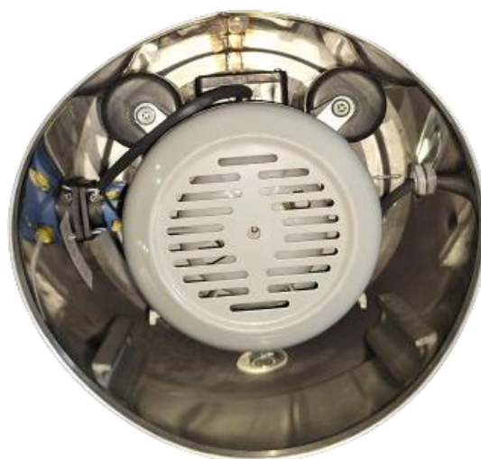
Figura # 1. Trinquete de Seguridad y detalle de Ventilación del Motor parte Inferior Abierta.
